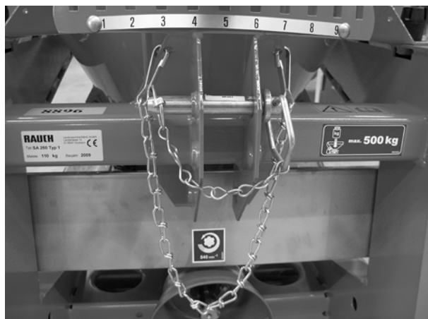
Bilde 6.8: Sikrede bolter
